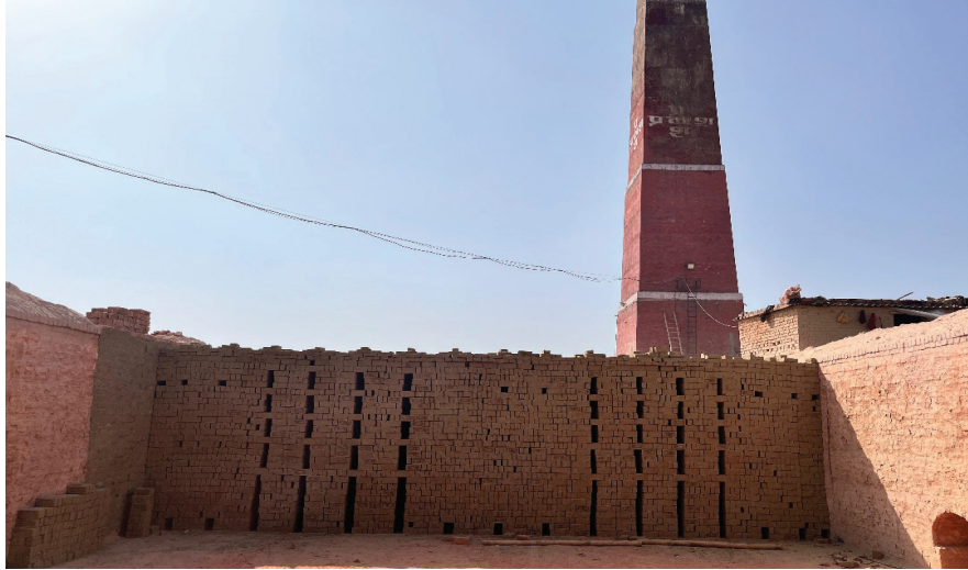
फोटो 24: डबल जिग जैग ईट जमावट: चैम्बर के साइड में स्थित वायु प्रवाह के लिए छिद्र
